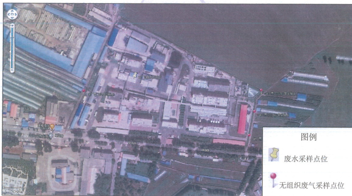
附图 2 无组织废气、废水采样点位
