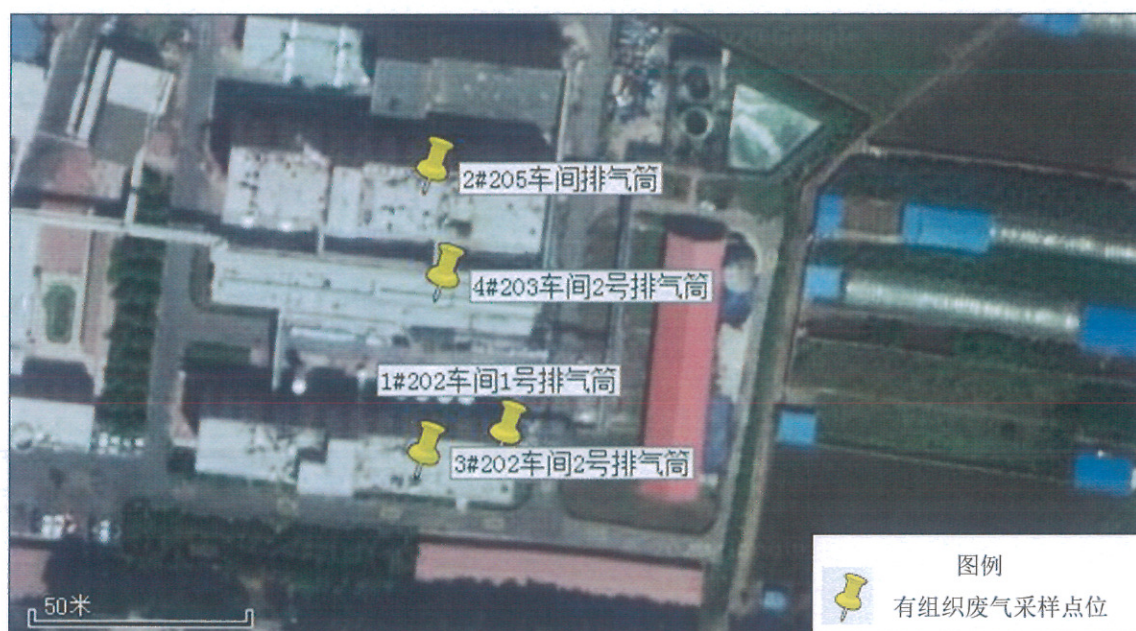
附图1 有组织废气采样点位示意图
