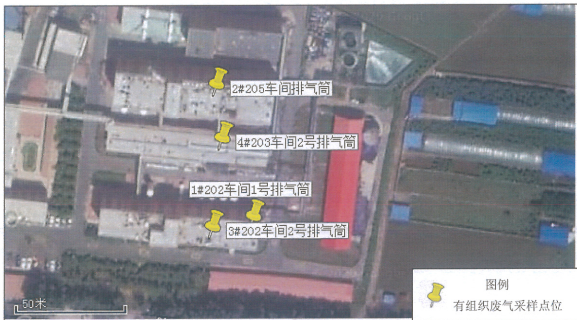
附图1 有组织废气采样点位示意图
